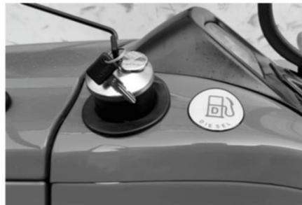
Fig. 5.2b: Tampa depósito de combustível ITL001894
